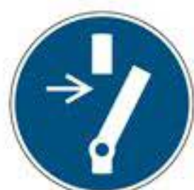
Vor Arbeiten freischalten DIN EN ISO 7010-M021
