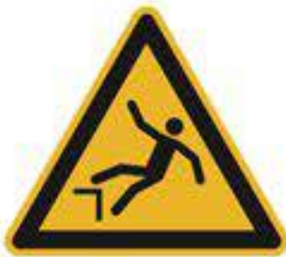
Warnung vor Absturzgefahr DIN EN ISO 7010-W008
