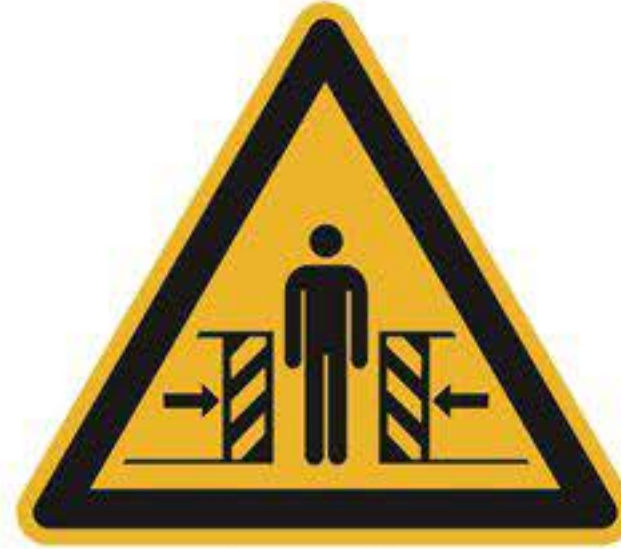
Warnung vor Quetschgefahr DIN EN ISO 7010-W019
