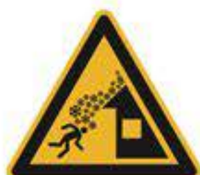
Warnung vor Dachlawine DIN EN ISO 7010-W040
