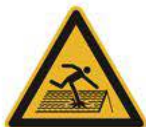
Warnung vor nicht durchtrittsicherem Dach DIN EN ISO 7010-W036
