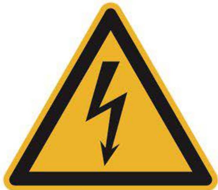
Warnung vor gefährlicher elektrischer Spannung DIN EN ISO 7010-W012 Symbolbezeichnung auch: WS 1
