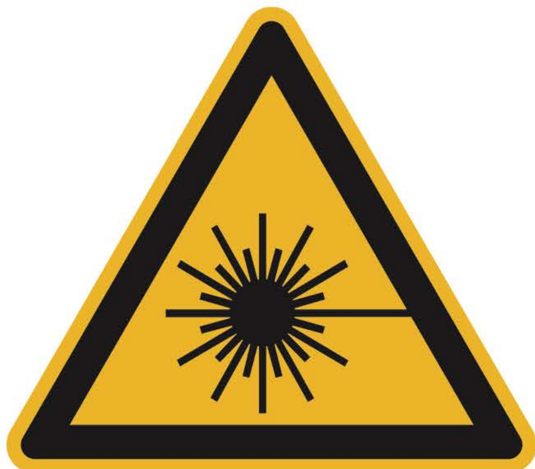
Warnung vor Laserstrahl DIN EN ISO 7010-W004
