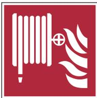
Löschschlauch DIN EN ISO 7010-F002
