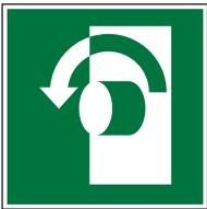
Öffnung durch Linksdrehung DIN EN ISO 7010-E018
