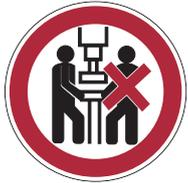
Maschine darf nur von einer Person bedient werden
