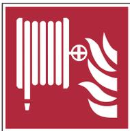
Löschschlauch DIN EN ISO 7010-F002
