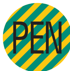
Neutralleiter mit Schutzfunktion/PEN-Leiter
