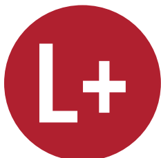
Gleichstrom Positiv nach DIN EN 60445 (VDE 0197)
