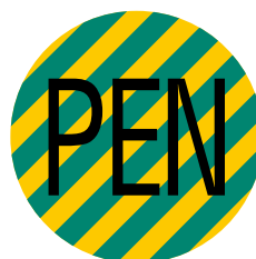
Neutralleiter mit Schutzfunktion/PEN-Leiter
