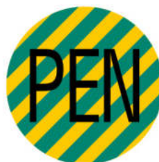
Neutralleiter mit Schutzfunktion/PEN-Leiter
