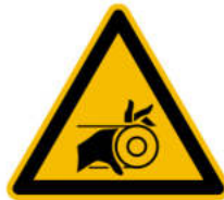
Warnung vor Handverletzung durch Riemenantrieb
