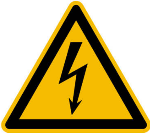
Warnung vor gefährlicher elektrischer Spannung DIN EN ISO 7010-W012
