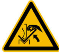
Warnung vor Quetschgefahr der Hand zwischen Presse und Werkstück DIN EN ISO 7010-W031
