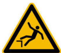
Warnung vor Absturzgefahr DIN EN ISO 7010-W008
