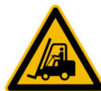
Warnung vor Flurförderzeugen DIN EN ISO 7010-W014
