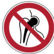
Kein Zutritt für Personen mit Implantaten aus Metall DIN EN ISO 7010-P014
