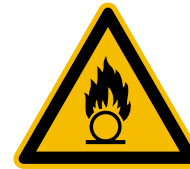
Warnung vor brandfördernden Stoffen DIN EN ISO 7010-W028
