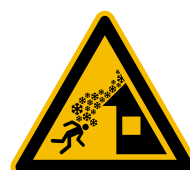
Warnung vor Dachlawine DIN EN ISO 7010-W040
