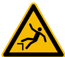
Warnung vor Absturzgefahr DIN EN ISO 7010-W008
