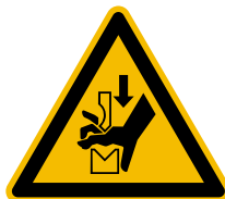
Warnung vor Quetschgefahr der Hand zwischen den Werkzeugen einer Presse DIN EN ISO 7010-W030
