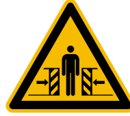
Warnung vor Quetschgefahr DIN EN ISO 7010-W019
